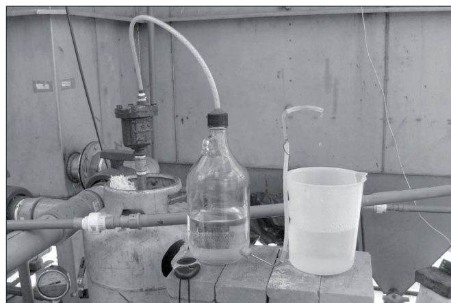
Figura 5 - Dispositivo desenvolvido para a quantificação do ar liberado durante a operação da bomba multifásica
