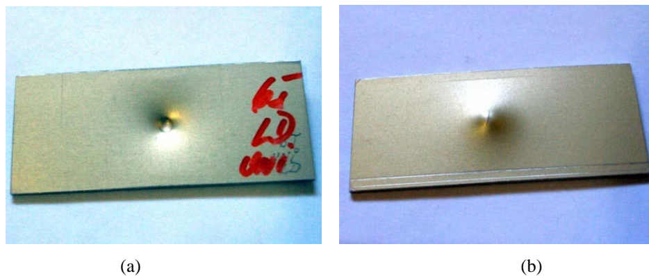
Figura 9: Respectivamente, faces frontal (a) e traseira (b) de um LMF danificado com um único impacto com energia de 6 J [24].
