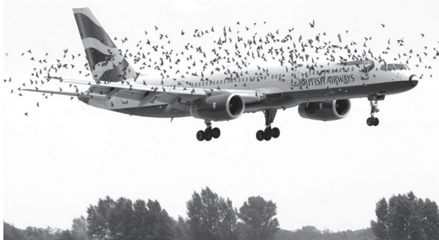
Figura 2. Curso de aterrisagem de uma aeronave comercial rodeada por um bando de pássaros, condição essa que pode resultar em danos de estruturas pelo choque com pássaros (Fonte: http://w1.rob.com/pix/oops?page=3 , Acesso em: março de 2007).
