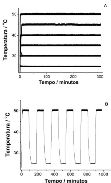
**Figura 4.** (A) Valores de  $T$  monitorada na câmara de envelhecimento em regime térmico constante. (B) Valores de  $T$  monitorada na câmara de envelhecimento durante ciclos de  $T$  entre as de 25 °C (90 min) e de 50 °C (90 min)
