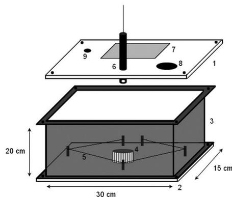
**Figura 1.** Representação das câmaras de envelhecimento acelerado. 1: chapa de PTFE superior; 2: chapa de PTFE inferior; 3: estrutura de aço inox; 4: ventoinha; 5: resistência interna; 6: sensor de T e UR de altura ajustável; 7: janela de vidro ou quartzo; 8: encaixe para o sistema de entrada de ar; 9: encaixe para a válvula de saída de ar
