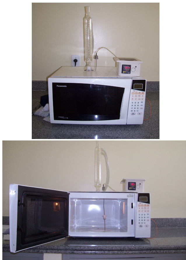
Figura 1 - (a) Forno de microondas doméstico adaptado para produção de biodiesel e (b) Parte interna do forno de microondas Determinação da potência do forno
