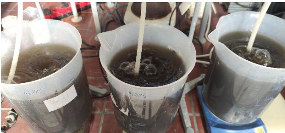
Slika 3-5: Preverjanje čiščenja NKV z aktivnim blatom
