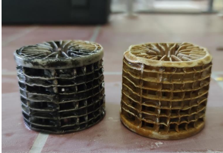
Slika 4-2: Razlika med potopljenim nosilcem in nosilcem v zraku v laboratorijski BČN
