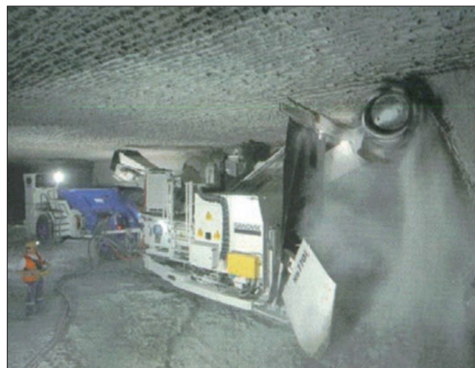
4 Continuous Miner Foto: Südwestdeutsche Salzwerte AG
