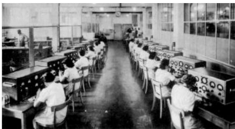
Abb. 54: Dioden-Prüffeld bei Intermetall , Düsseldorf 1953. (Abbildung aus „Neue Intermetall-Kristalloden“, Funkschau 1953, S. 351.)
