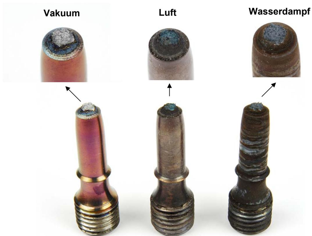
**Abbildung 4.39:** Makroskopische Aufnahme der Bruchoberflächen
