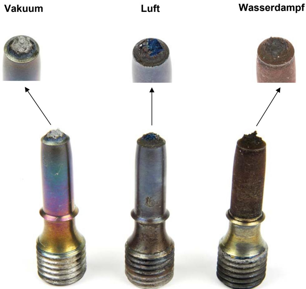
**Abbildung 4.65:** Makroskopische Aufnahme der Bruchoberflächen an den Proben aus X22
