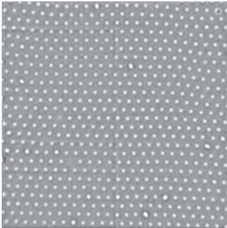
**Abbildung 3-5: Mikroskopisches Bild einer geordneten Probe,  $\Phi=1,04 \cdot 10^{-2}$**
