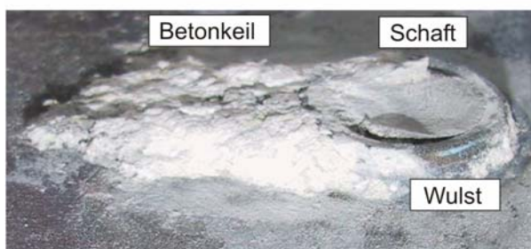
Bild 4.19: Tragmechanismus eines Kopfbolzendübels im Bruchzustand und Modellierung des Schweißwulstes
