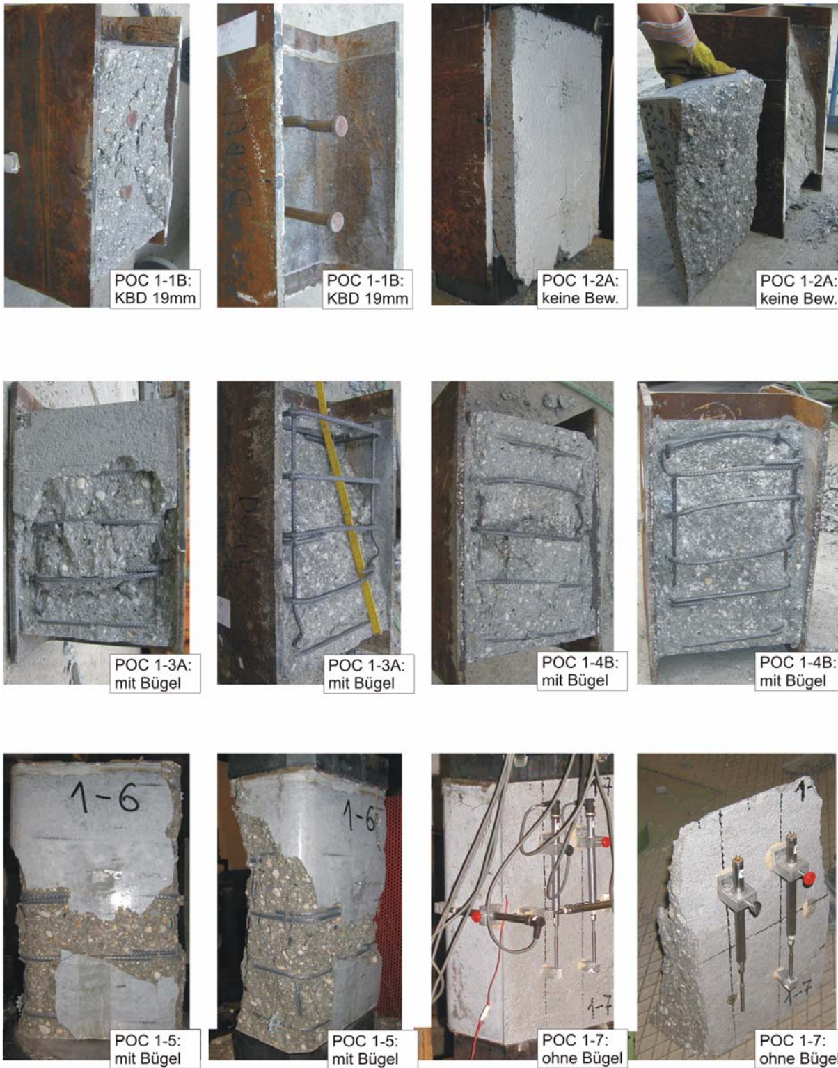
Bild A7.4: Charakteristische Versagensbilder der Kompressionskörper
