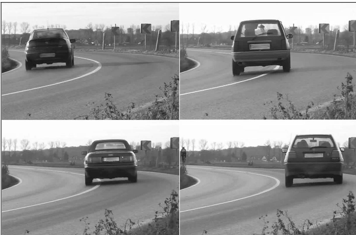
**Bild 69:** Klassifizierung der Spurhaltetypen (oben links: extremes Schneiden; oben rechts: starkes Schneiden; unten links: moderates Schneiden; unten rechts: Normalverhalten)
