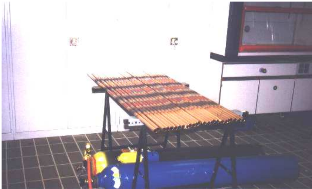
Abbildung 4-12: Zwischenlagerung der Kupferrohre nach der Wärmebehandlung
