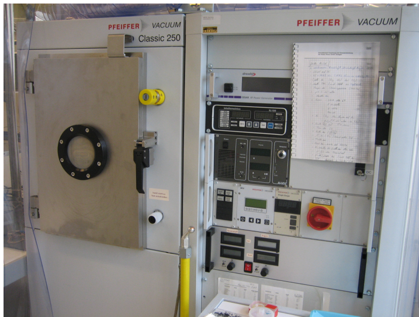
Abbildung 7.3: Sputteranlage zur Herstellung der Sensoren; die Anlage ermöglicht es auch reaktiv Iridium- und Rutheniumoxidstrukturen abzuscheiden
