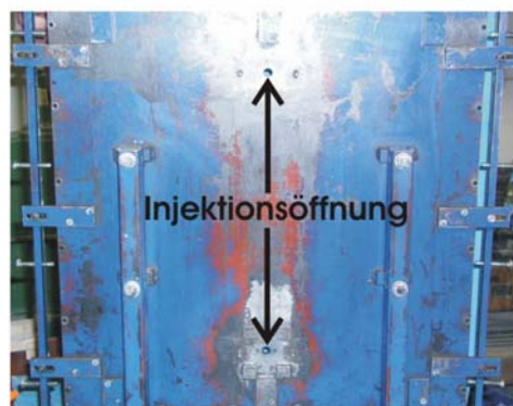
Bild 4-37: Betonieren einer Scheibe durch Injizieren des Betons
