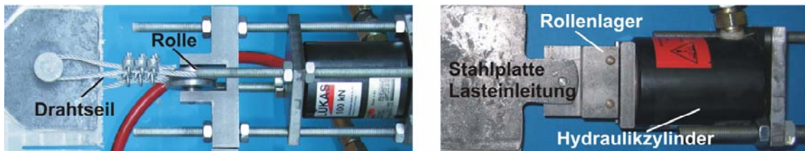
Bild 4-35: Einleitung der Zugkräfte (links) und Druckkräfte (rechts) in die Scheiben
