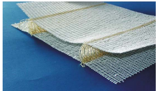
Bild 2-9: 3D-Gelege mit tragenden Aramidabstandsfäden /Bra04/
