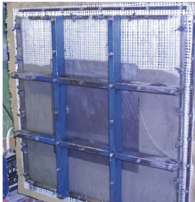
Bild 4-37: Betonieren einer Scheibe durch Injizieren des Betons
