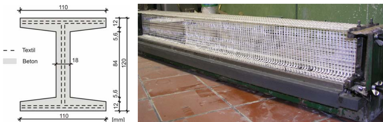
Bild 6-1: Querschnitt der I-Profil-Balken (links) und Bewehrungseinbau (rechts)
