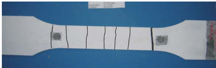
Bild 4-8: Rissbilder der Dehnkörper mit Bewehrung aus Einzelrovings
