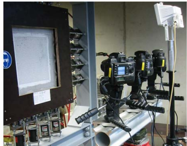
Bild 4-39: Messtechnik während der Scheibenversuche: Wegaufnehmer (links) und Photogrammetrie (rechts)
