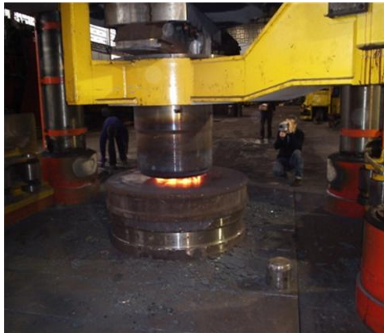
Figura 8: Imágenes de la prensa de forja en funcionamiento. Arriba, previamente a la aplicación de la fuerza, y abajo, en el momento de aplicación de la fuerza
