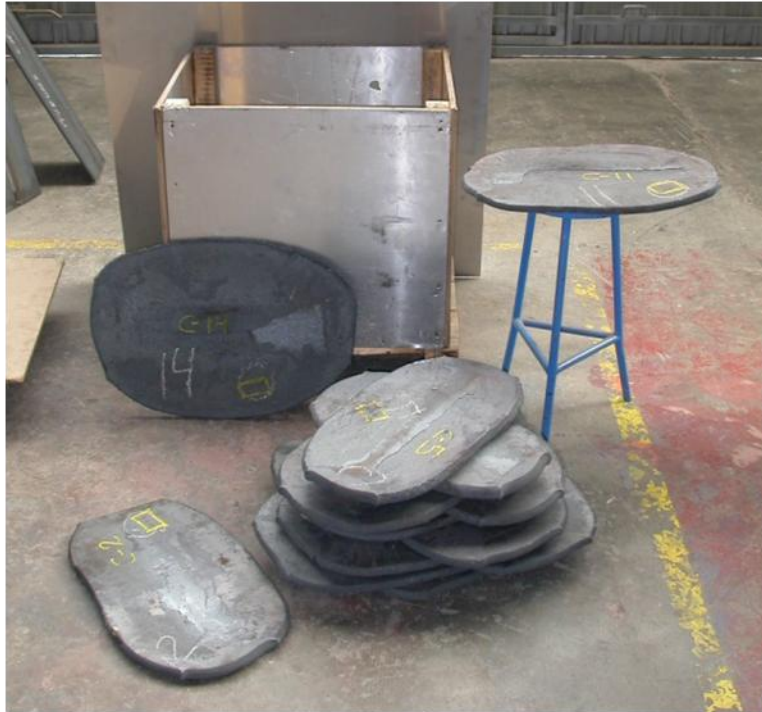
Figura 9: Tortas obtenidas tras el proceso de forja
