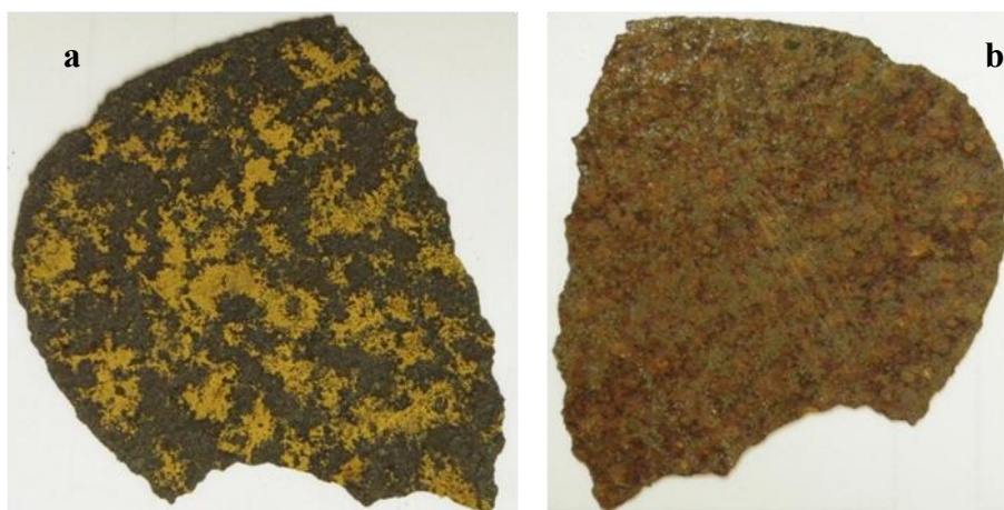
Figura 69: Aspecto visual de las dos caras de la capa de herrumbre externa: a) superficie en contacto con la capa interna de herrumbre y b) superficie en contacto con la atmósfera. Acero 1 transcurrido un mes de ensayo cíclico SAE J2334
