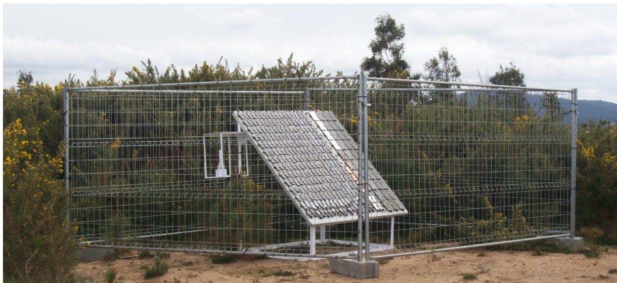
Figura 22: Estación atmosférica de corrosión
