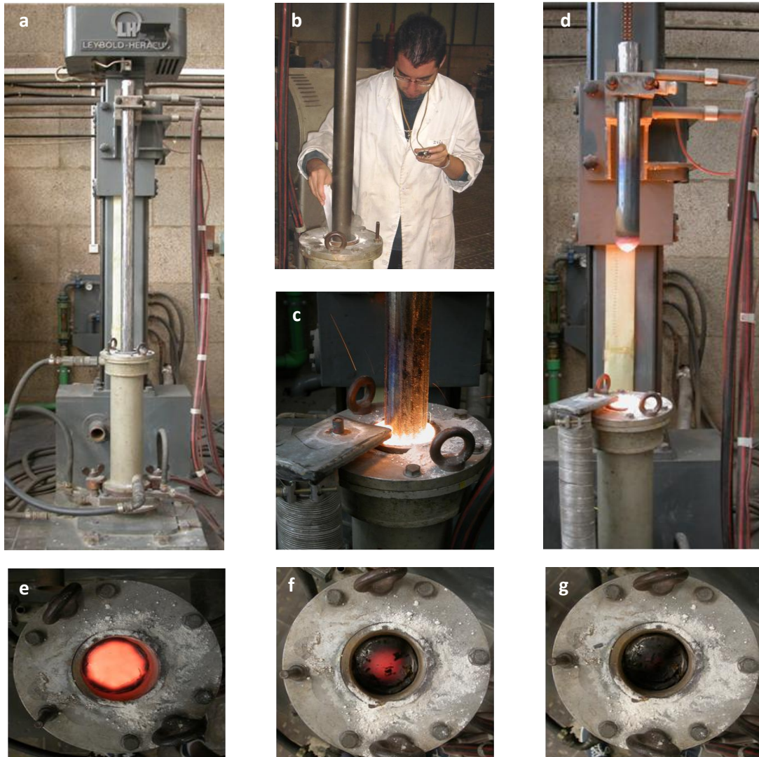
Figura 6: Esquema del proceso de refusión por electroescoria (ESR): a) Horno ESR, b) Adicionando aleantes, c) Horno ESR en funcionamiento, d) Finalización de la refusión y e, f y g) Secuencia de enfriamiento del lingote
