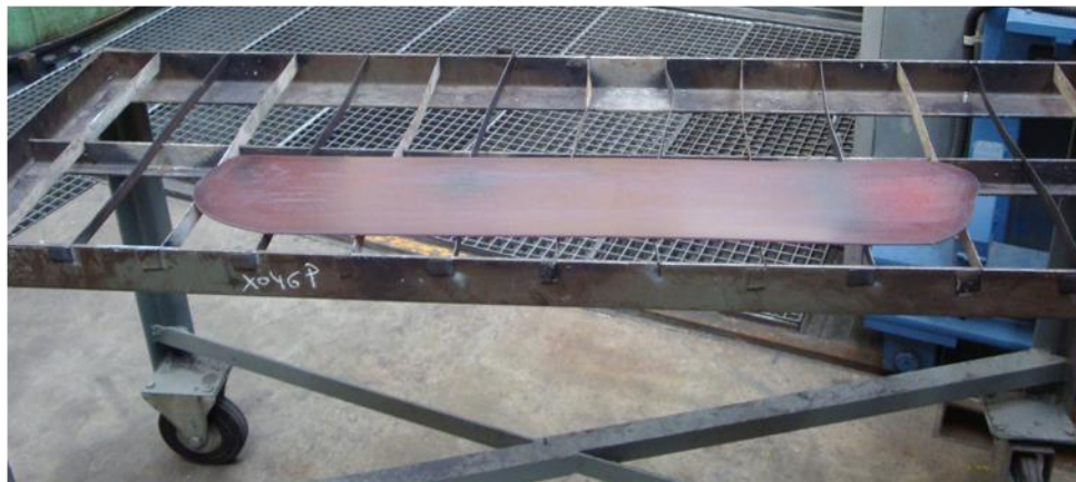
Figura 11: Pieza laminada enfriándose al aire
