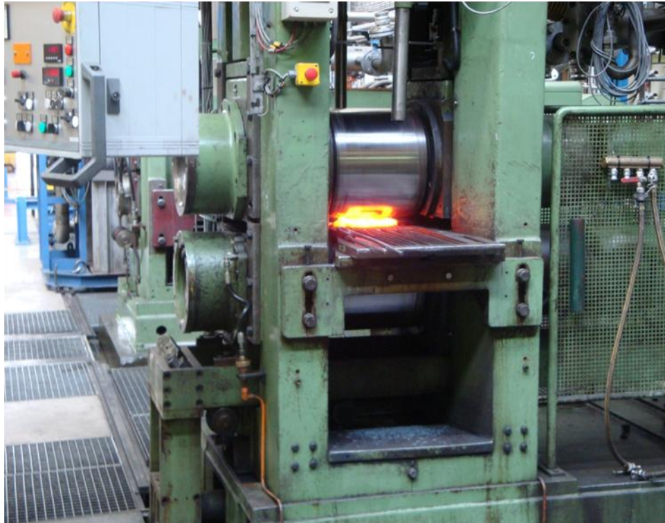
Figura 10: Laminadora en caliente utilizada
