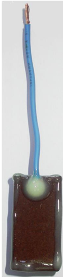
Figura 16: Probeta que ha estado expuesta a la atmósfera, preparada para el ensayo EIE
