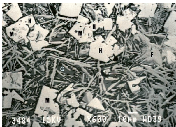
Figura 11. Microestructura de una muestra de sinterizado fabricado en el ensayo 6, con presencia de fases muy entremezcladas (x600). H = hematita; M = magnetita; F = red de ferritos aciculares y columnares; G = ganga. Presencia de poros (negro).
