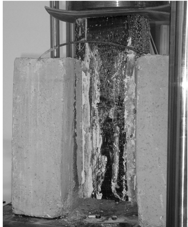
Figura 11. Detalle del fallo en la probeta C.
