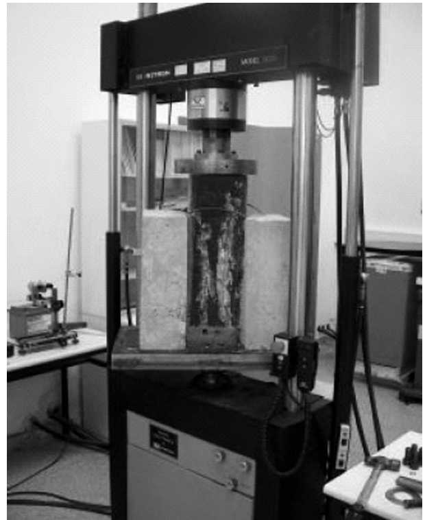
Figura 7. Ensayo de "push-out" de un conector.
