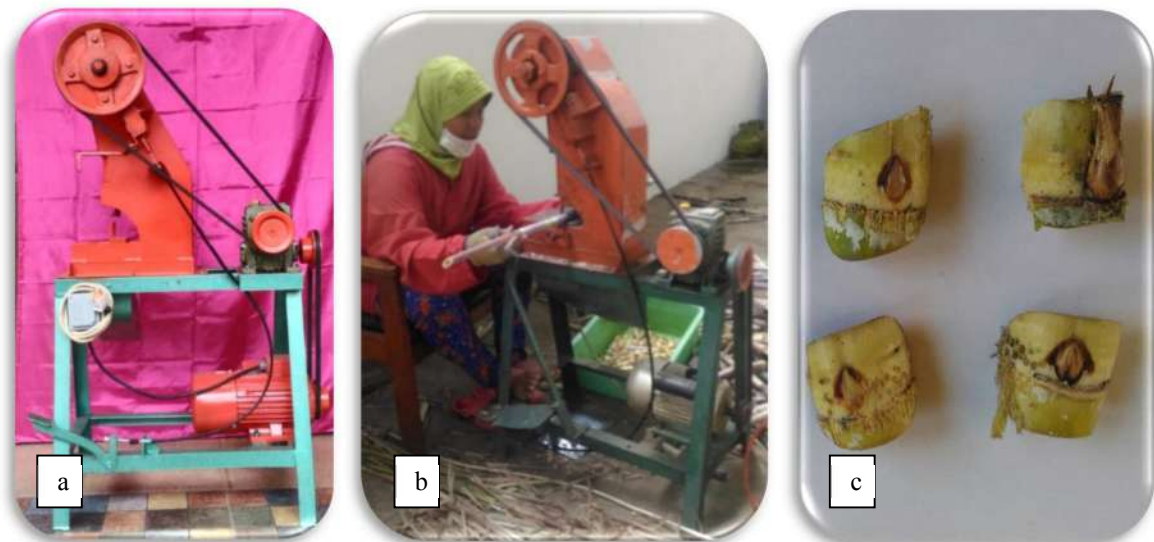
Gambar 2. Bud chipper (a), Operator (b), dan (c) Bud chip yang siap digunakan sebagai bahan tanam
