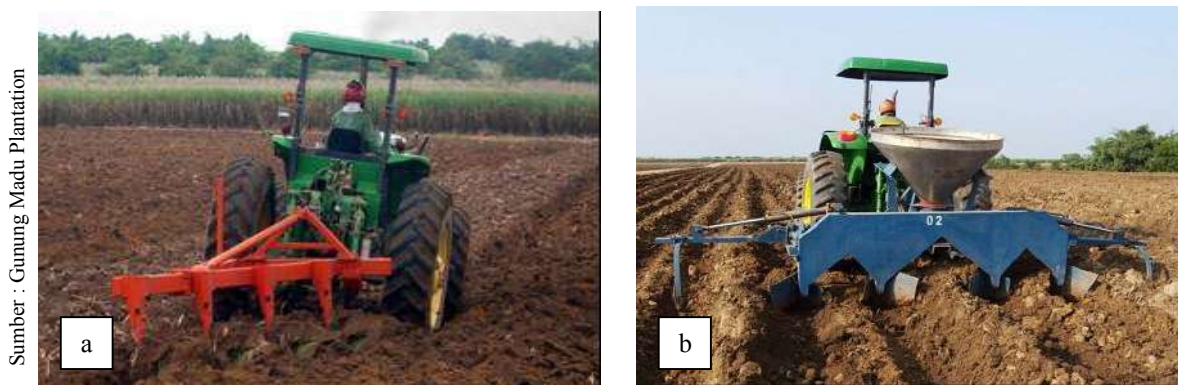
Gambar 5. Pengolahan tanah (a) dan pembuat alur tanam dan pemupukan (b)
