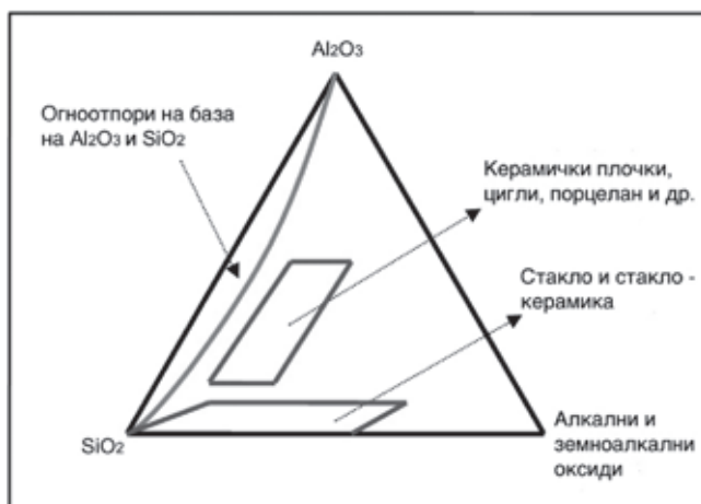
Слика 10.13.1. Состав на најчестите керамичките производи Figure 10.13.1. Composition of common ceramic products (Zimmer, 2010)
