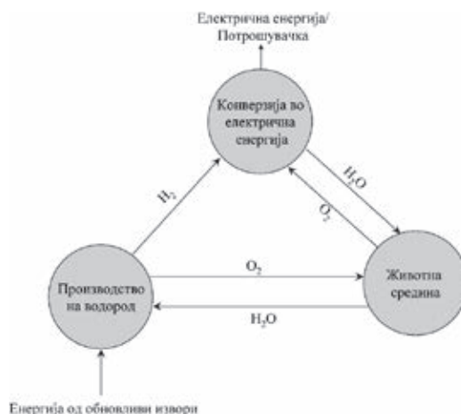
Слика 10.9.2. Затворен циклус на експлоатација на водородот во водородната економија Figure 10.9.2 Closed-loop hydrogen exploitation in hydrogen economy
