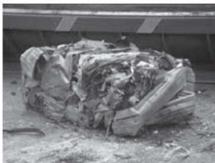
Слика 10.12.1. Балирање на стари автомобили Figure 10.12.1. Baling of old cars (JMC Recucling systems LTD, 2011) Jems Ltd
