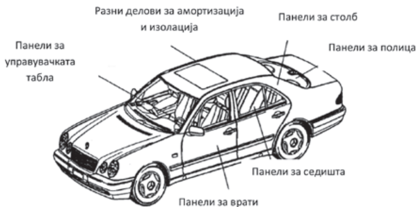
Слика 7.4. Примена на полимерни еко – композити во автомобилска индустрија
