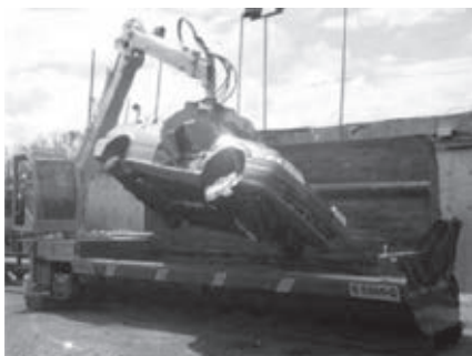
Слика 10.12.1. Балирање на стари автомобили Figure 10.12.1. Baling of old cars (JMC Recucling systems LTD, 2011) Jems Ltd
