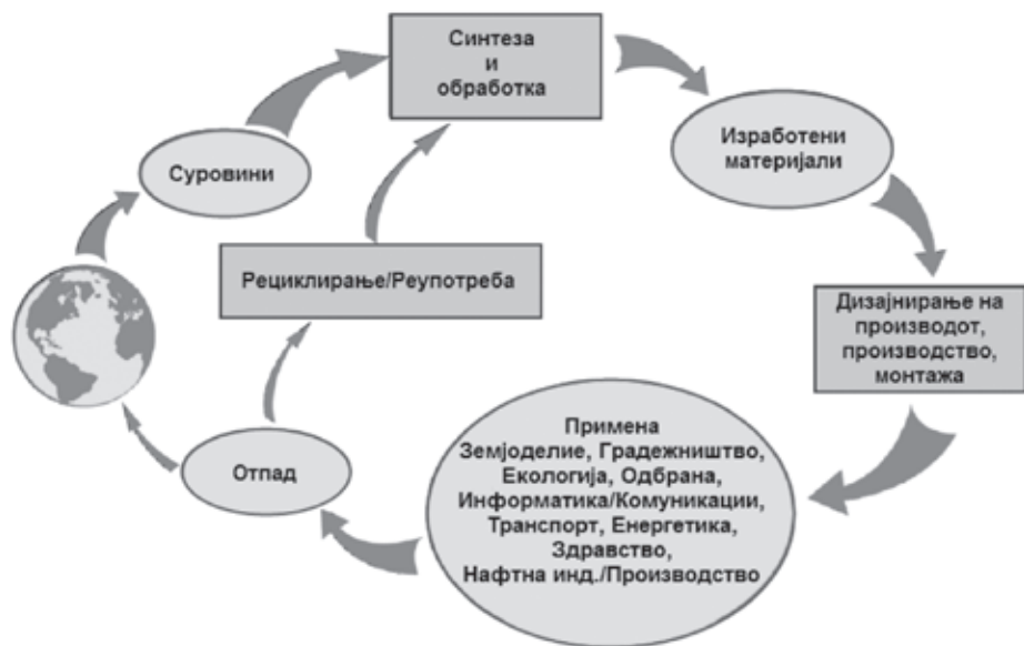
Слика 10.10.3. Шематски приказ на вкупниот циклус на материјали Figure 10.10.3. Schematic representation of the total cycle of materials (Callister, 2001)
