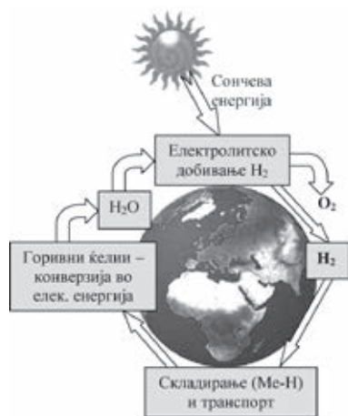
Слика 10.9.1. Круг на водородната економија Figure 10.9.1. Hydrogen economy cycle
