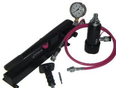
Figura 5.7 Attrezzatura Pull Out.
