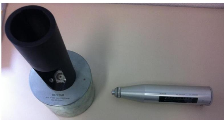
**Figura 3.6** Sclerometro meccanico GEI Concrete.
