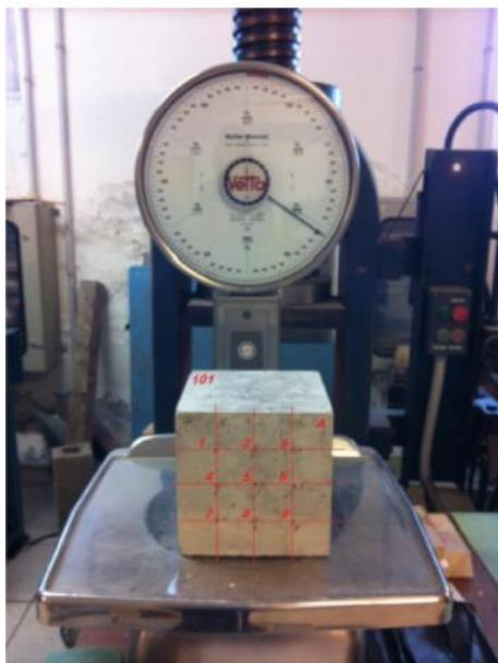
**Figura 3.4** Grigliatura del provino per l'esecuzione delle prove.
