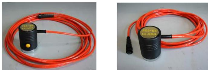
Figura 5.5 Trasmittitore TSG-55 (a sinistra) e Ricevitore RSG-55 (a destra)
