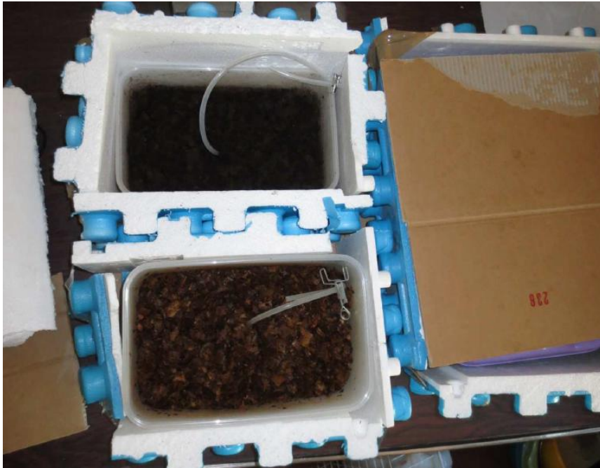
Figura 9.73 Veduta dei reattori utilizzati per le prove di compostaggio
