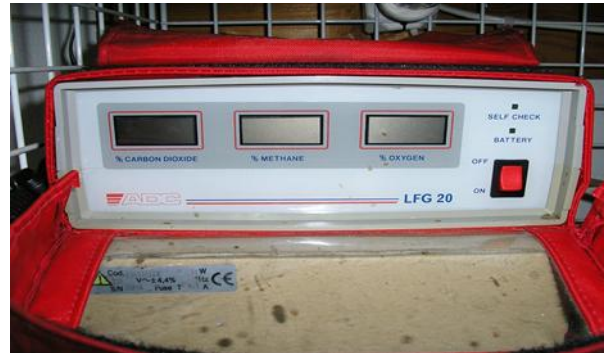
Figura 8.4 (a) Analizzatore ECOCONTROL modello ECO3; (b) Analizzatore ECOCONTROL modello LFG20
