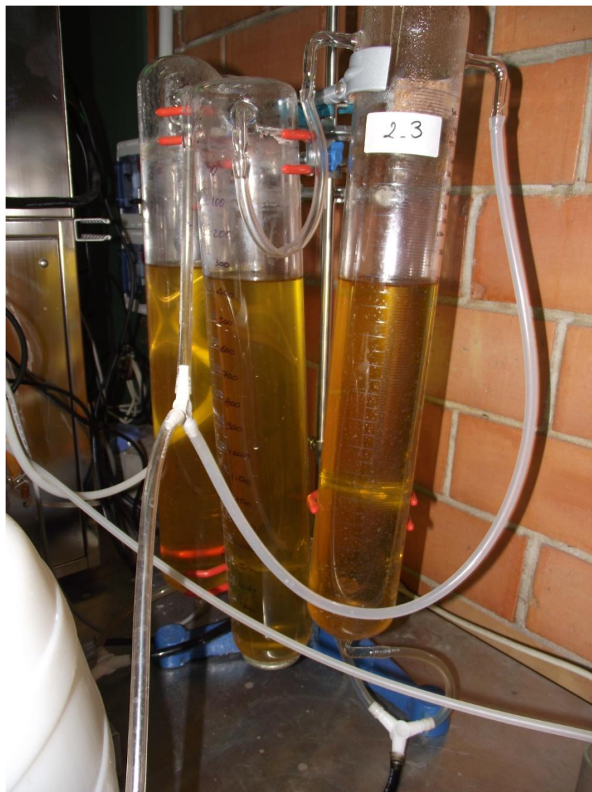
Figura 8.3 Colonne in vetro per la determinazione del volume di gas prodotto
