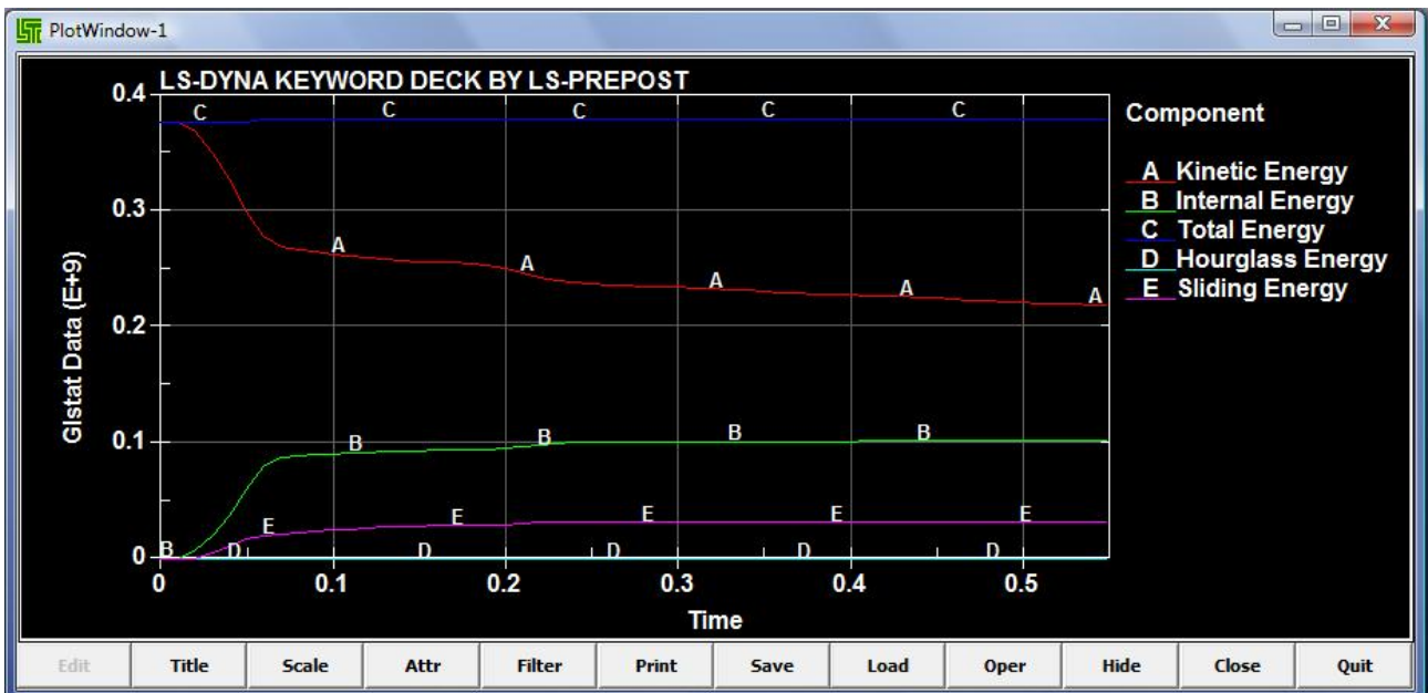
Energia modello con montanti e nastri \phi 250 impatto sullo spazio libero T=20 e U=25\%
