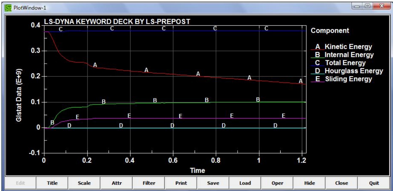
Energia modello con montanti e nastri \phi 200 impatto sullo spazio libero T=1 e U=30\%
