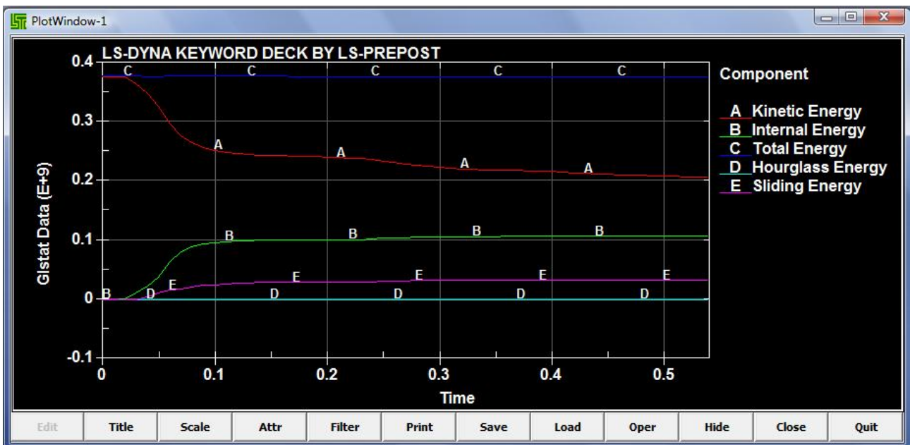
Energia modello con montanti e nastri \phi 200 impatto sullo spazio libero T=20 e U=25\%
