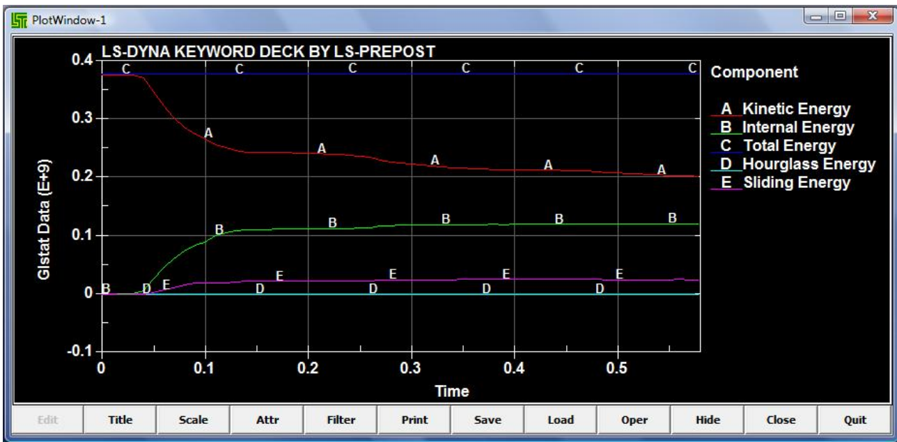
Energia modello con montanti e nastri \phi 250 impatto sul montante T=20 e U=20\%
