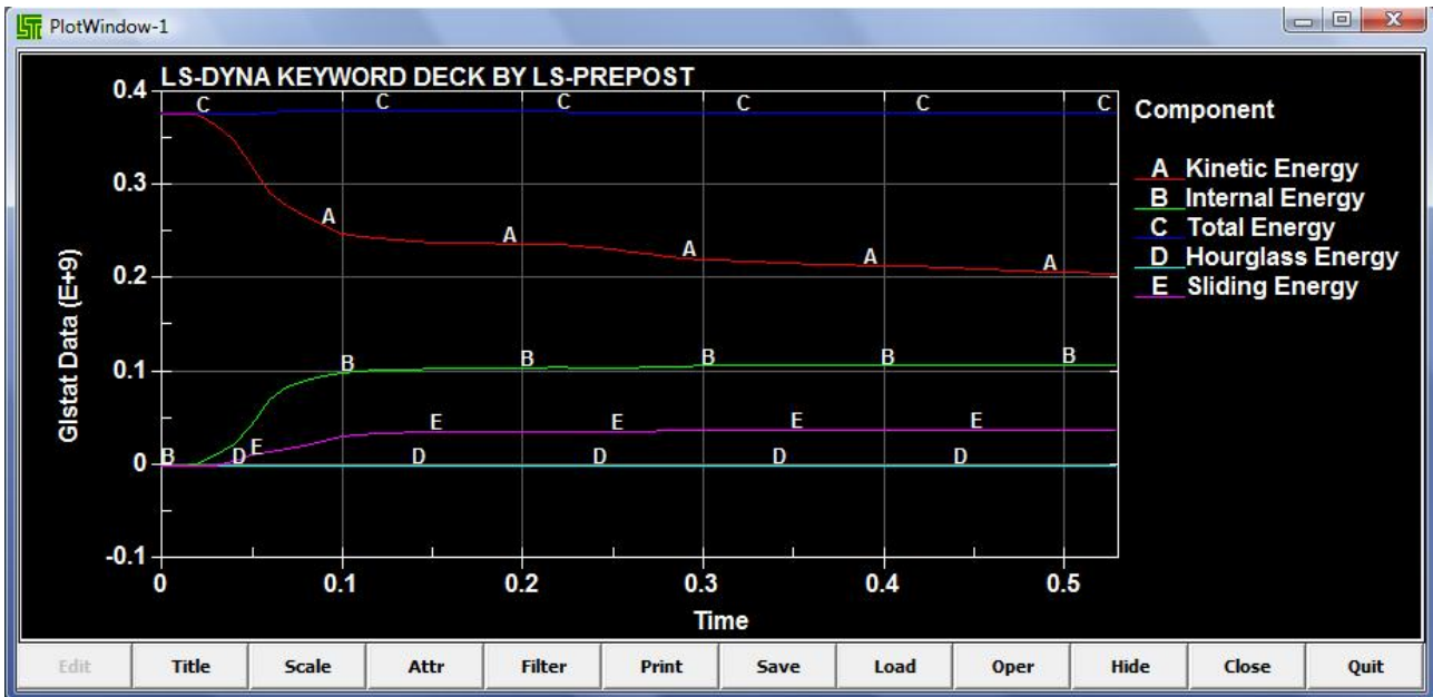
Energia modello con montanti e nastri \phi 250 impatto sullo spazio libero T=10 e U=30\%
