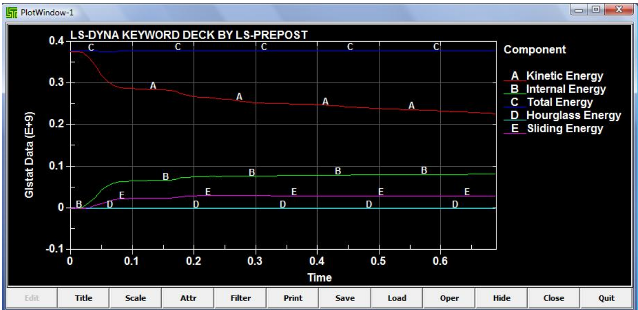
Energia modello con montanti e nastri \phi 250 impatto sullo spazio libero T=20 e U=20\%
