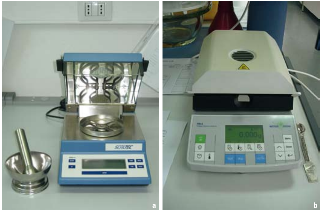
Figura 5.9. Ejemplos de analizadores electrónicos de humedad o termobalanzas utilizadas en la Banca del Germoplasma della Sardegna, BG-SAR (a) y en el Banc de Llavors Forestals, CIEF (b).
