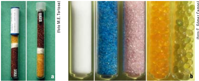
Figura 6.2 (a) De izquierda a derecha: tubo de vidrio cerrado a la llama; tubo con rosca para colecciones activas. (b) De izquierda a derecha: gel de sílice sin indicador; gel con indicador de \text{Cl}_2\text{Co} anhidro; idem hidratado; gel con indicador de violeta de metilo anhidro; idem hidratado.
