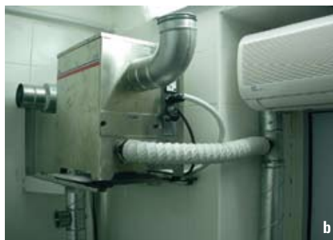
Figura 6.5. (a) Cámaras para ultradesecar semillas en presencia de gel de sílice. (b) Máquina de desecación basada en un circuito con gel de sílice, utilizada en el Centro Conservazione Biodiversità de Cagliari.
