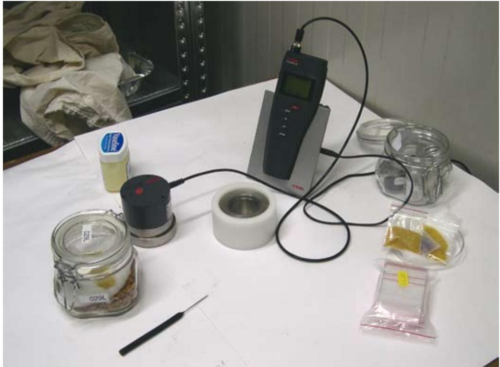
Figura 5.21- Instrumentos para la medición de la actividad del agua ( a_w ) y humedad relativa en equilibrio utilizado en el Mediterranean Agronomic Institute of Chania . (Creta).
