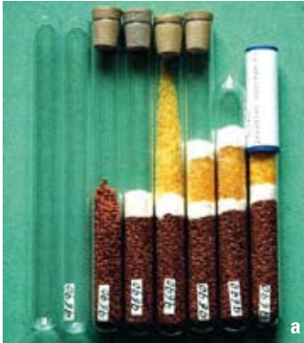
Figura 6.6 (a) Fases en la elaboración de ampollas de vidrios con semillas y gel de sílice a partir de un tubo de laboratorio que se cierra a la llama. (b) Soplete con doble entrada (para gas y aire) para cerrar tubos de vidrio .
