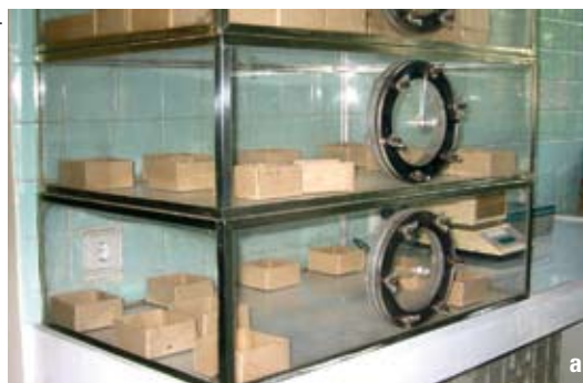
Figura 6.5. (a) Cámaras para ultradesecar semillas en presencia de gel de sílice. (b) Máquina de desecación basada en un circuito con gel de sílice, utilizada en el Centro Conservazione Biodiversità de Cagliari.
