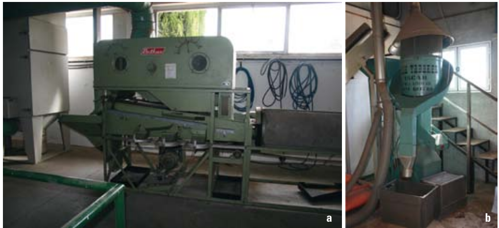
Figura 5.8 a- Máquina de flujo de aire con cilindro dentado para la separación de semillas utilizado en el CNINGF “El Serranillo”; b- Máquina de flujo de aire para la limpieza de grandes lotes de semillas utilizada en el Banc de Llavors Forestals, CIEF.
