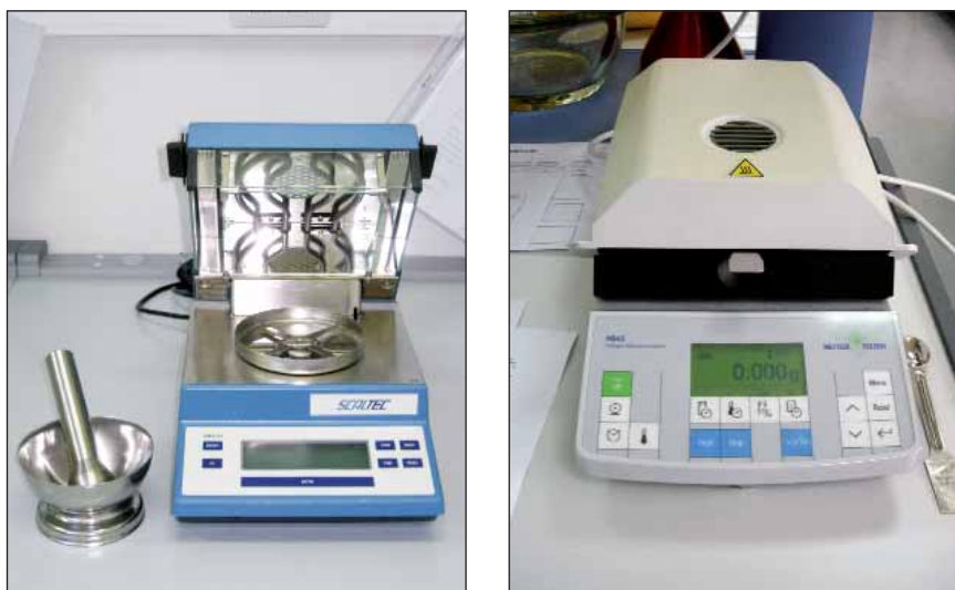
Figura 20 – Esempi di analizzatori elettronici di umidità o termobilance, in uso presso la Banca del Germoplasma della Sardegna (BG-SAR) e al Banc de Llavors Forestals (CIEF). (foto: E. Mattana)
