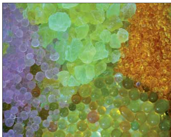
Figura 24 – Esempi di diverse tipologie di gel di silice autoindicante presenti sul mercato. (foto: E. Mattana)
