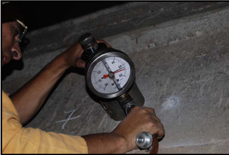
Foto 6.44: prova di pull-out trave E 7
