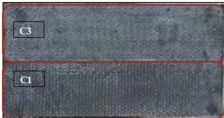
Figura 28. Fotografia dei provini. Nella parte superiore: C3 con difetti di adesione, nella parte inferiore: C1 con perfetta aderenza.
