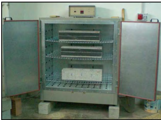
Figura9. Provini Serie B nel forno. Dall'alto verso il basso: C2_perfetta aderenza, C4_difetti, C10 non rinforzato.
