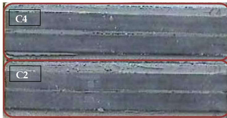
Figura 52. Fotografia dei provini. Nella parte superiore: C4 con difetti di adesione, nella parte inferiore: C2 con perfetta aderenza.
