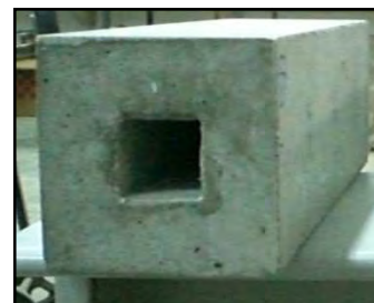
Figura 23. Cavità nei travetti
