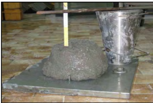
Figura 4. Prova al cono di Abrams.
