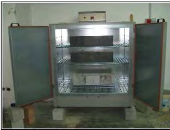
Figura 4. Provini Serie A nel forno. Dall'alto verso il basso: A1_perfetta aderenza rete/calcestruzzo; A3_difetti; provino non rinforzato.
