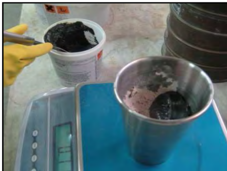
Figura 34. Pesata dei componenti A e B.
