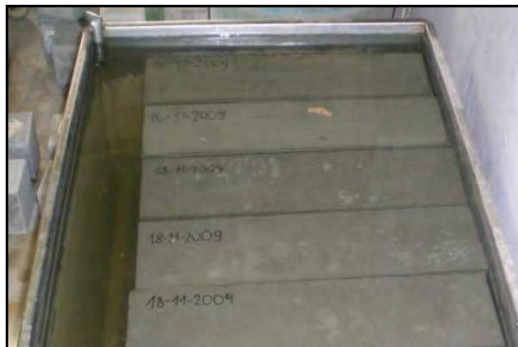
Figura 9. Maturazione in vasca dei provini.
