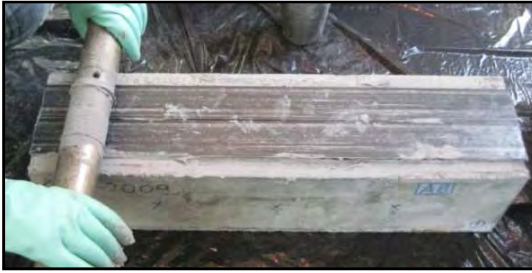
Figura 38. Passaggio del rullo per la fuoriuscita delle bolle d'aria e della resina in eccesso.
