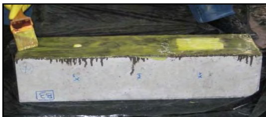
Figura 29. Stesura del primo strato di resina.
