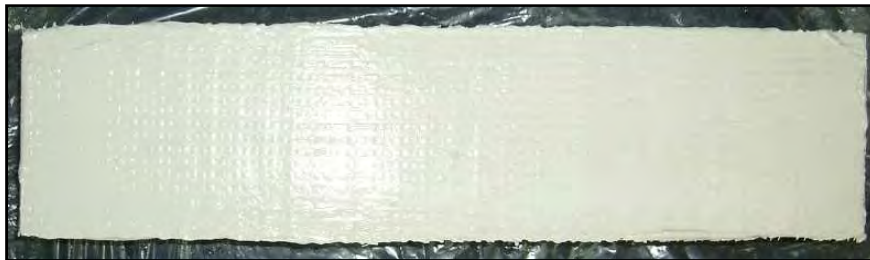
Figura 44. Travetto rinforzato con la rete in PBO.
