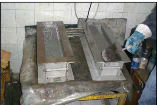
Figura 6. Getto dei travetti sulla piastra vibrante.
