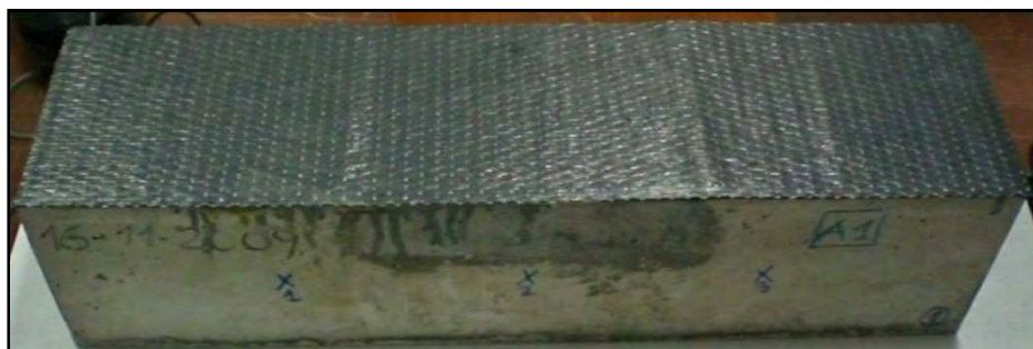
Figura 33. Travetto rinforzato con la rete FRP dopo la polimerizzazione.
