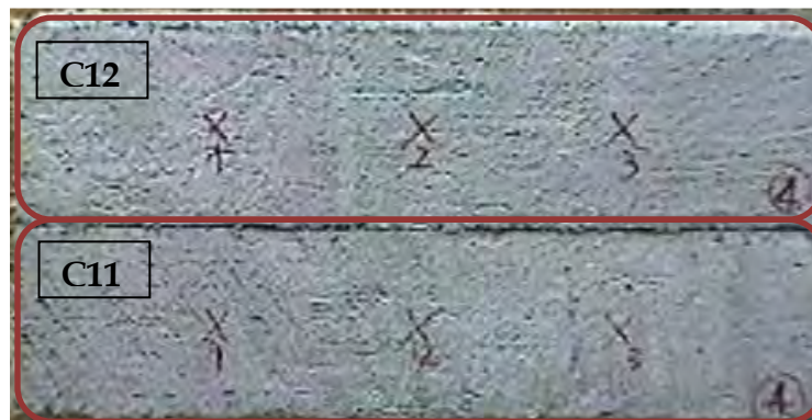
Figura 79. Fotografia dei provini. Nella parte superiore: C12 con difetti di adesione, nella parte inferiore: C11 con perfetta aderenza.
