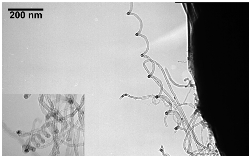
Fig. 6.7 Nanotubi a struttura elicoidale osservati impiegando il catalizzatore di FeCo-SiO 2 al 10%.
