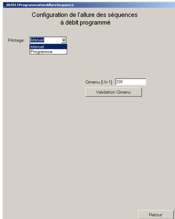
Figure 94 : Fenêtre de gestion manuelle de la pompe de la boucle externe
