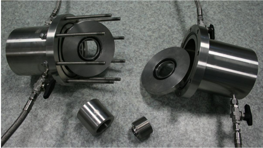
Figure V-7 : Compartiment de diffusion pour les membranes de VV.
