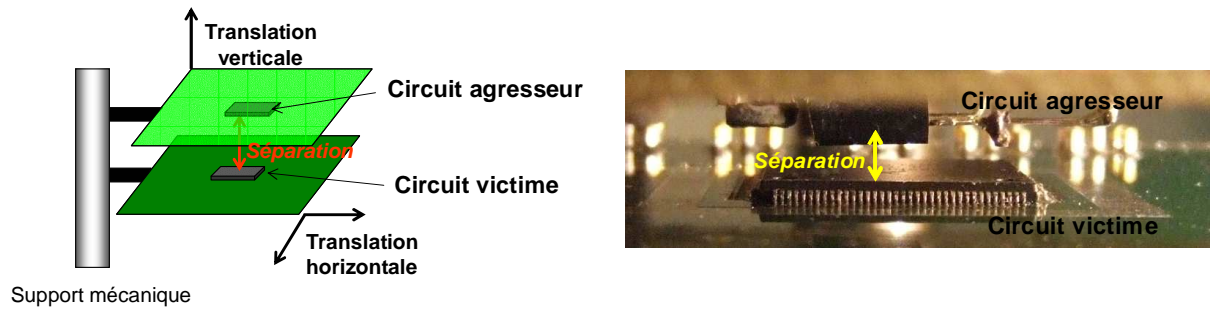
Figure 4-1 - Démonteur du rapprochement de deux circuits intégrés : principe du support mécanique (gauche) et configuration du rapprochement (droite)
