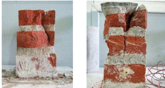
Figure 49 - Essais sur sandwichs. Photos après rupture.
