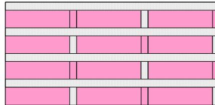
Figure 47 - Construction numérique d'un mur en brique à l'aide d'un élément de base répété en translation.
