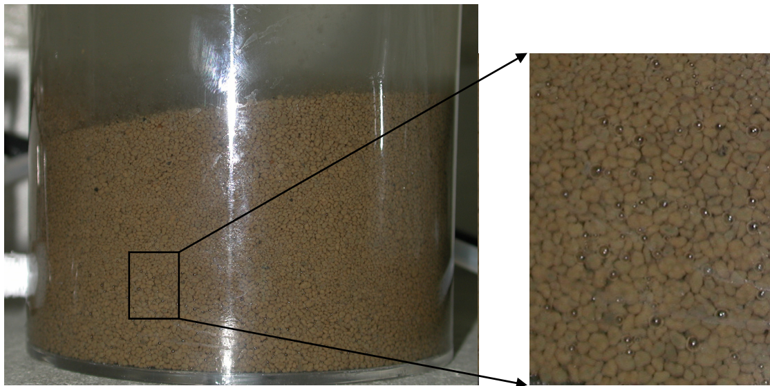
Figure III.2. Interface boue granulaire/zone 2 et formation de bulles de biogaz
