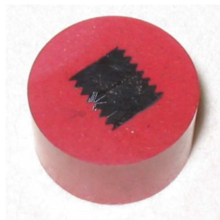
Figure 6.7 : Coupe longitudinale d'une vis.
