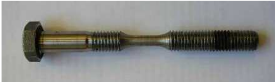
Figure 3.7 : Géométrie des éprouvettes de traction prélevées dans les boulons.
