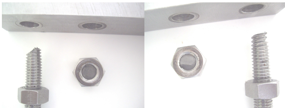
Figure 4.32 : Vues de détail des ruptures des boulons.
