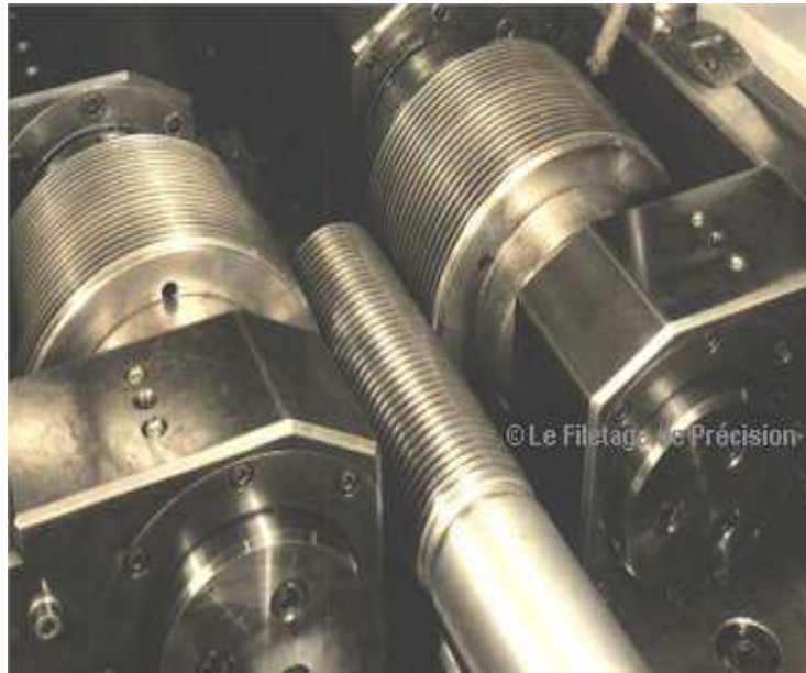
Figure 6.2: Machine à rouler à deux molettes.
