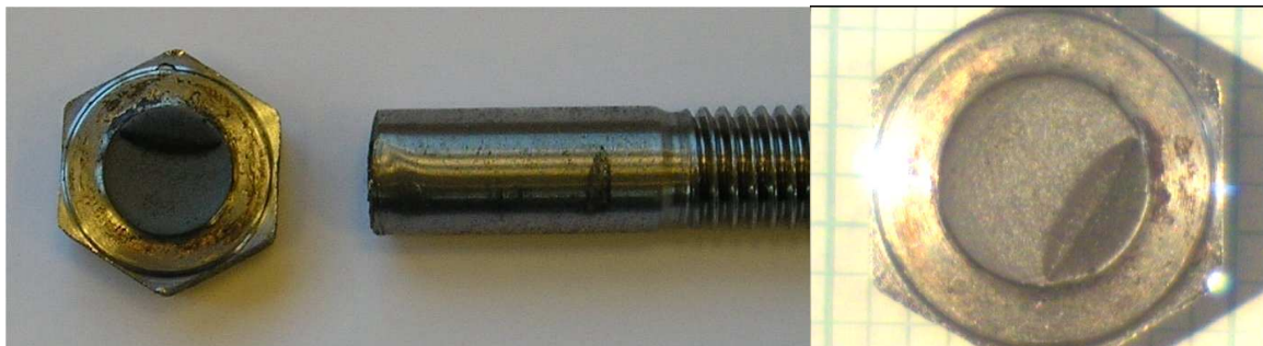
Figure 1.8 : Rupture sous tête.
