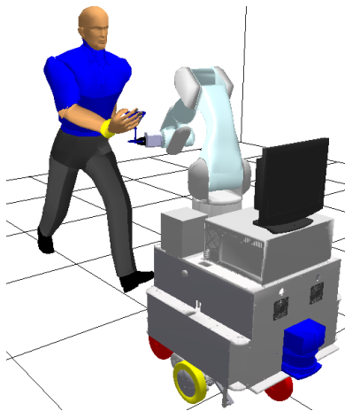
Figure 19 – Echange d’un objet, le planificateur génère deux saisies, une est exécuté par le robot et l’autre nous dit qu’au mois l’objet est saisissable, même si nous ne pouvons pas garantir que l’humain trouvera la même prise.
