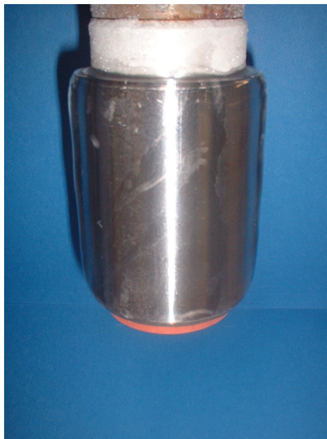
Figure IV.7 Couche de glace régulière, formée sur le tambour du système de type Couette.
