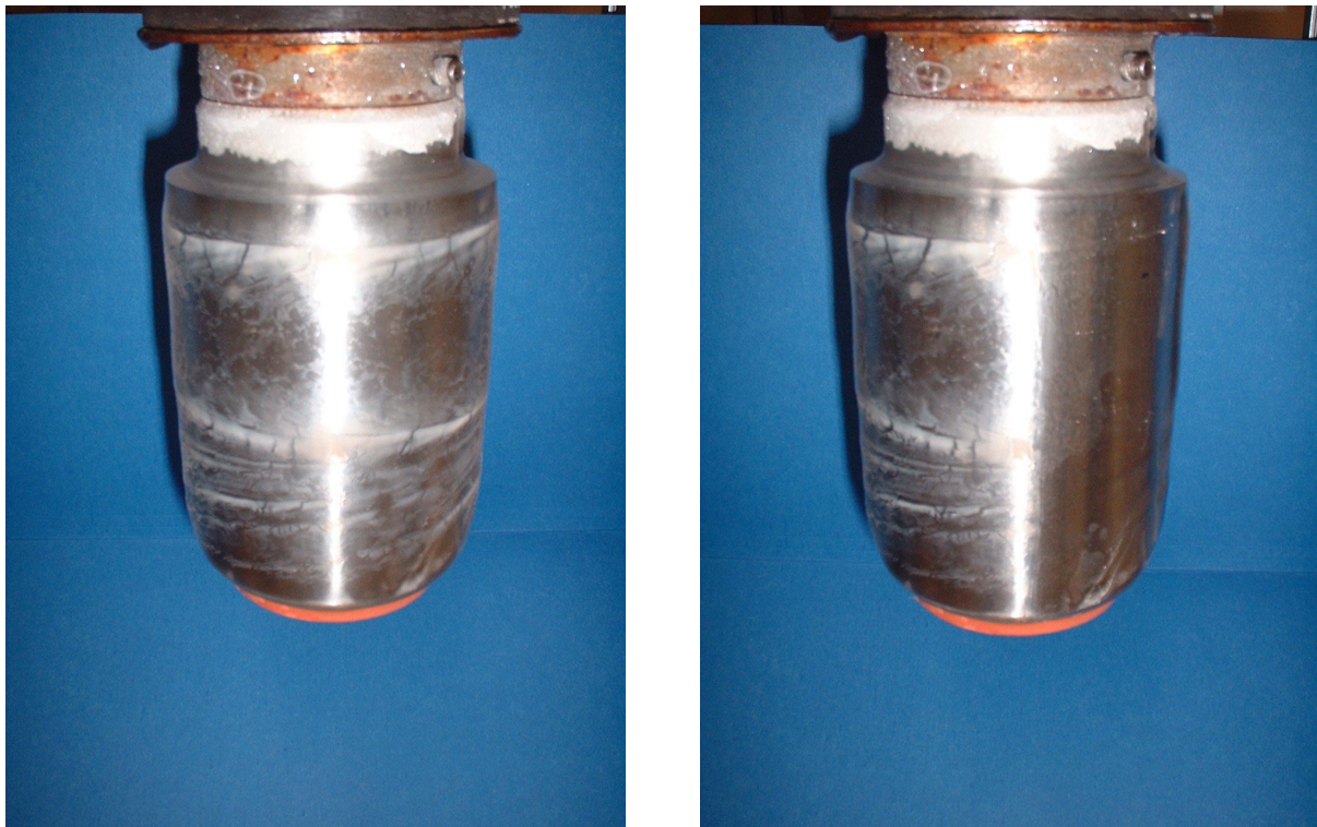
Figure V.8 Couche de glace obtenue lors des essais avec la bentonite. A gauche : couche de glace initiale, et à droite : couche de glace rincée sur la moitié droite de la surface.
