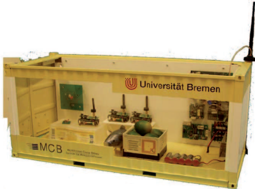
Figura 2.18: Sensores desplegados en el interior de un contenedor de transporte [60]
