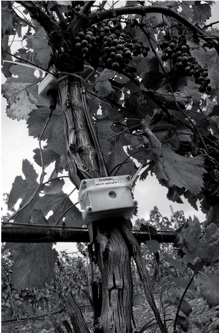
Figura 2.10: Detalle de nodo sensor utilizado en el proyecto Wisevine
