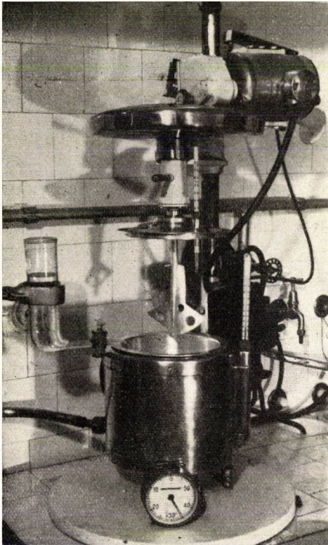
2. ábra. A kísérletekhez használt emulziókészítő berendezés (Konstrukció POLSTER A.-tól.)
