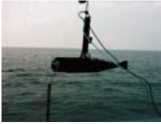
Figuur 2.3: Met de Meetvis worden zwevend stofmonsters in het oppervlaktewater op zee genomen (foto RIKZ).
