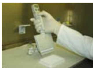
Figuur 2.4: De bioassays ER-CALUX ® , DR-CALUX ® en Mutatox ® worden uitgevoerd in microtiterplaten zoals hierboven weergegeven. Deze plaat bevat 96 kleine vaatjes, 'wells', met een volume van 0,3 ml (foto: RIKZ).
