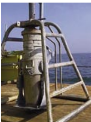
Figuur 2.2: Met de boxcore worden sedimentmonsters op de oppervlakte van de zeebodem genomen (foto RIKZ).
