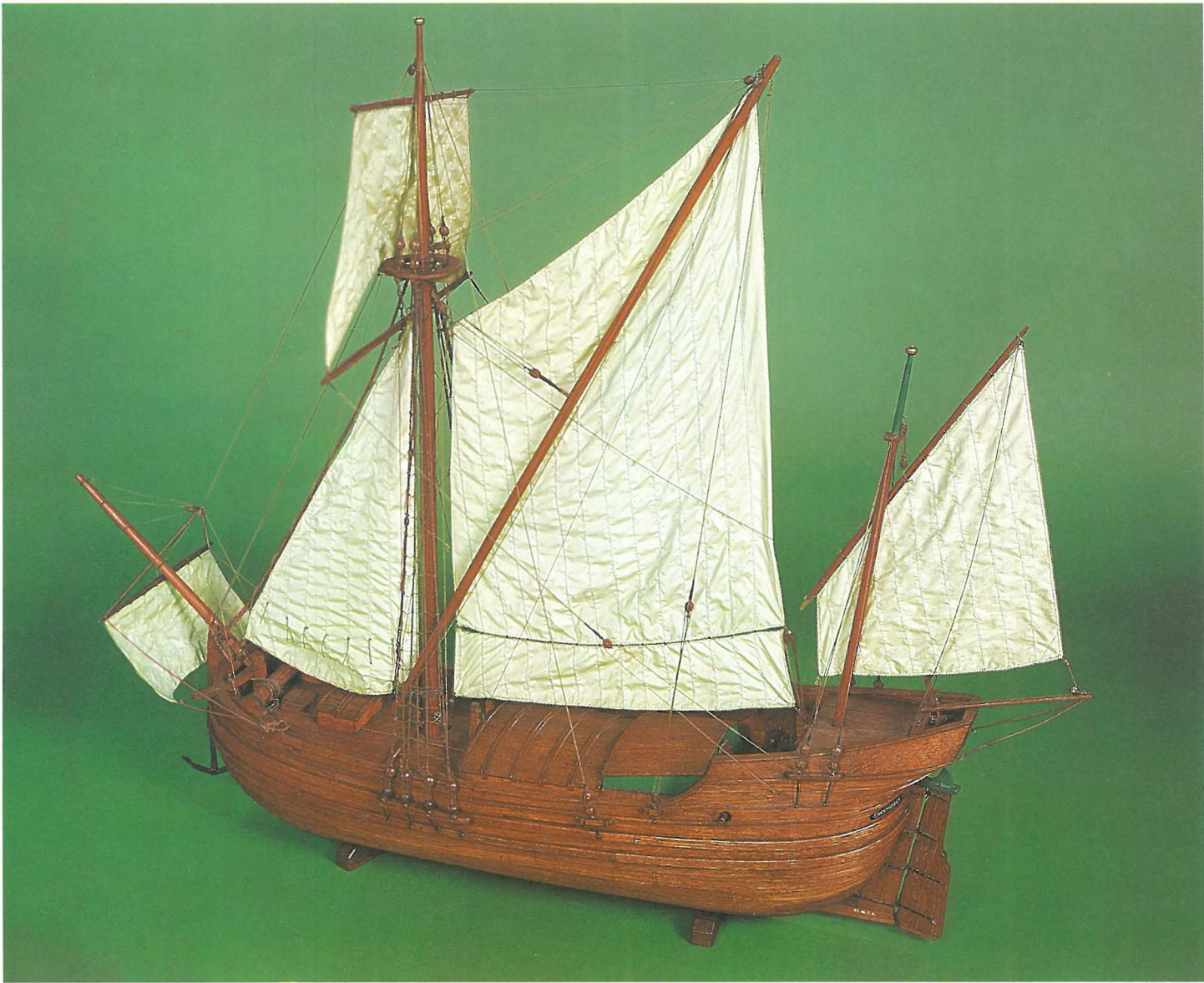
53. Model van een boeier. Kustvaarder getuigd met een anderhalfmasttuig waarvan het grootzeil een sprietzeil is, 1570. Reconstructie. Antwerpen, Nationaal Scheepvaartmuseum.
