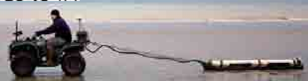
Een DUALEM-21S bodemsensor voortgetrokken door een quad op het strand (BE). © K. Vandevorst/Onroerend Erfgoed/A2S
