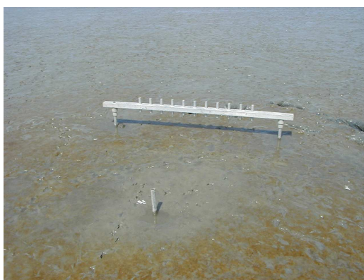
Figuur 2-1. Sederopplot met meetrij en schematische voorstelling van de oriëntatie ten opzichte van de dijk.
