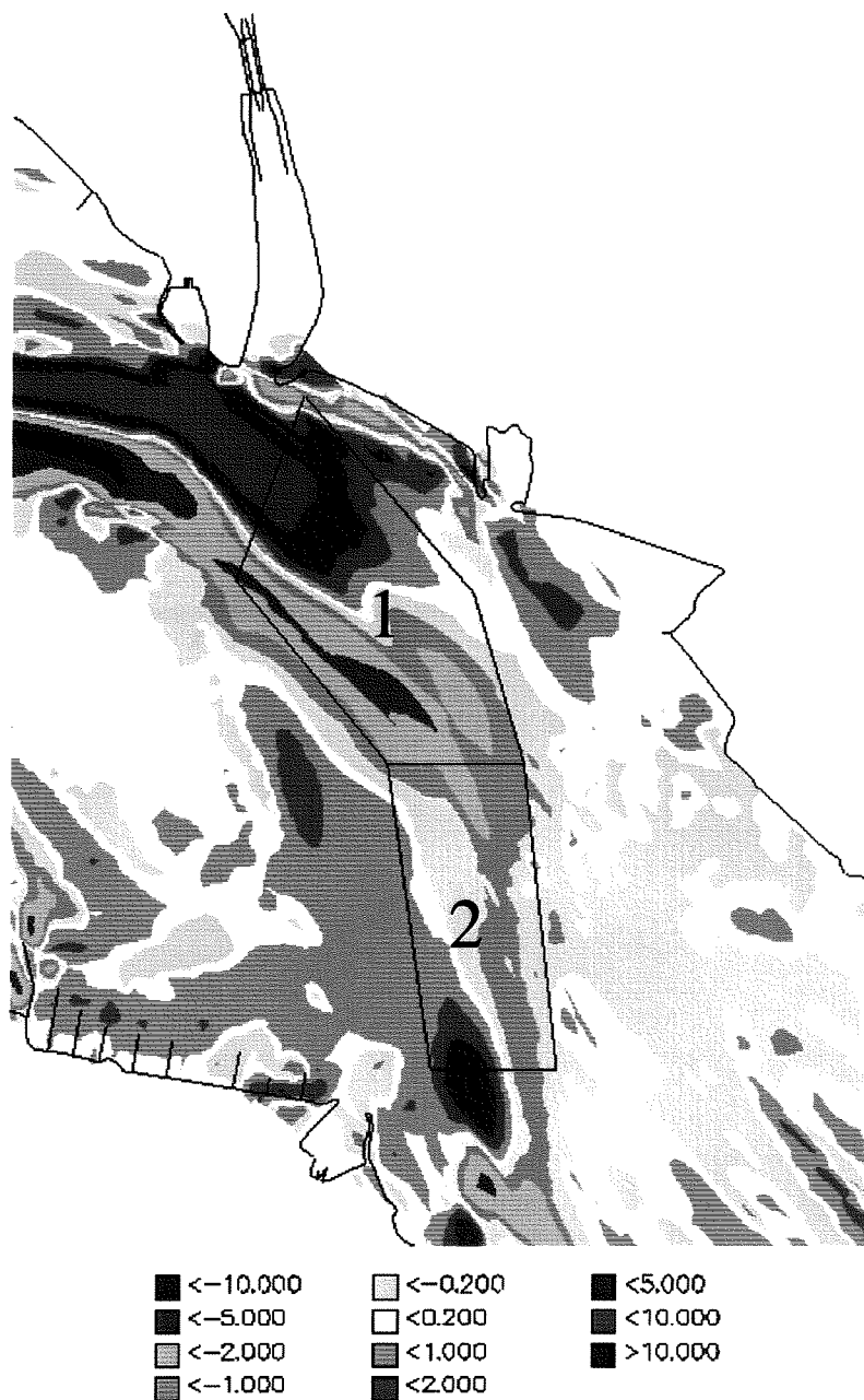
Figuur 7.7 Sedimentatie- en erosiepatronen na 1 jaar bodemontwikkeling: lokaties Vak 1 en Vak 2.
