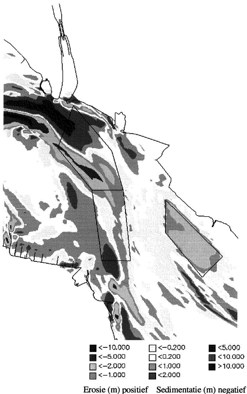
Figuur 4.19 Sedimentatie- en erosiepatronen na 1 jaar bodemontwikkeling; lokaties Vak 1, Vak 2 en Vak Schaar van Waarde (maandelijks storten in Schaar van Waarde).
