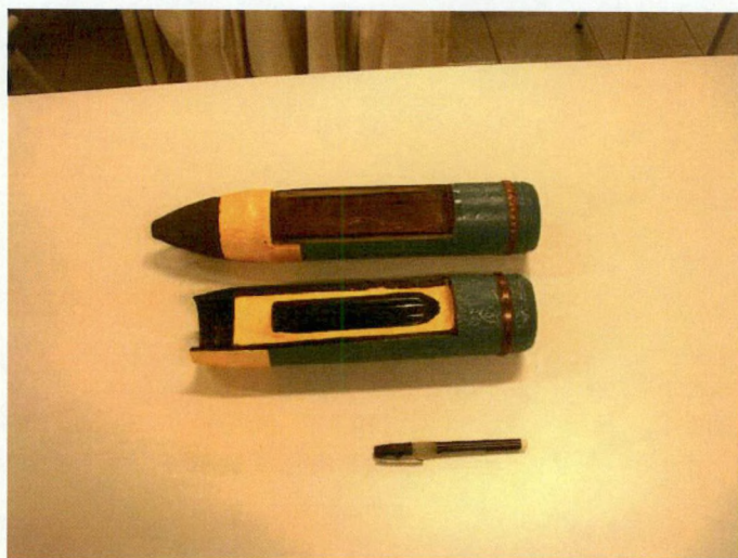
Figuur 1.1: Dwarsdoorsneden van 77 mm obussen met chemische lading. Bovenaan is een typische obus met Ypriet of (di)fosgeen lading. Onderaan is een Clark obus met binnenin het glazen flesje en de lading springstof errond te zien.
