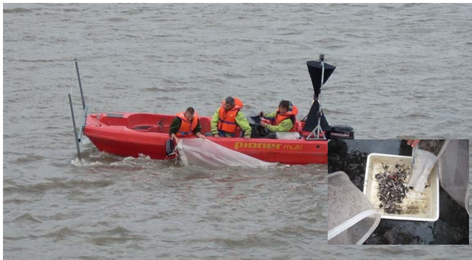
Figuur 2. Glasaalbemonstering in de Zeeschelde m.b.v. de glasaalnetten. De twee conische netten worden bevestigd aan het frame op de voorkant van de boot en worden langs beide zijden van de boot gesleept tegen de vloedstroom in. De netten hangen op ongeveer 0.5 m diepte, zijn 2 m lang en hebben een opening van 0.5 m diameter.
