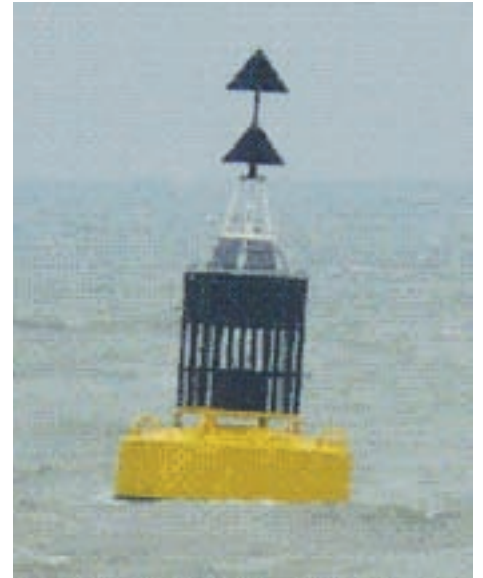
■ Een kardinale boei is geel-zwart gekleurd. Bij deze noordkardinale boei, duidt het topteken erop dat de boei ten noorden ligt van een hindernis onderwater. Het lichtkarakter aangeduid met Q is een wit licht dat continu knippert (VH)
