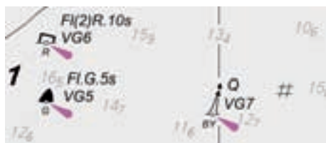
■ Op dit stukje van de kaart zie je drie boeien in de vaargeul naar Zeebrugge. Het symbooltje linksbovenaan toont een rode, laterale, stompe boei met een rood licht. Fl(2)R.10s betekent dat deze boei een groepschitterlicht geeft. Het licht knippert twee maal en dan blijft het donker gedurende de resterende 6 seconden. Samen duurt zo'n cyclus dus 10 seconden. Het symbooltje links onderaan is een groene, spitse laterale boei. Fl.G.5s betekent dat deze boei een groen schitterlicht geeft dat eens om de 5 seconden knippert. Deze boei dient dus aan stuurboordzijde gepasseerd te worden om de juiste vaarroute te bevaaren. Het symbooltje rechts staat voor een meerkleurige, zwart-geel horizontaal gestreepte kardinale boei (VH)
