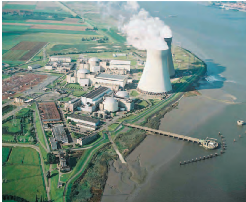
● Voor de productie van elektriciteit zijn grote hoeveelheden koelwater nodig. Dit koelwater wordt opgepompt uit de Schelde via de watervang.
