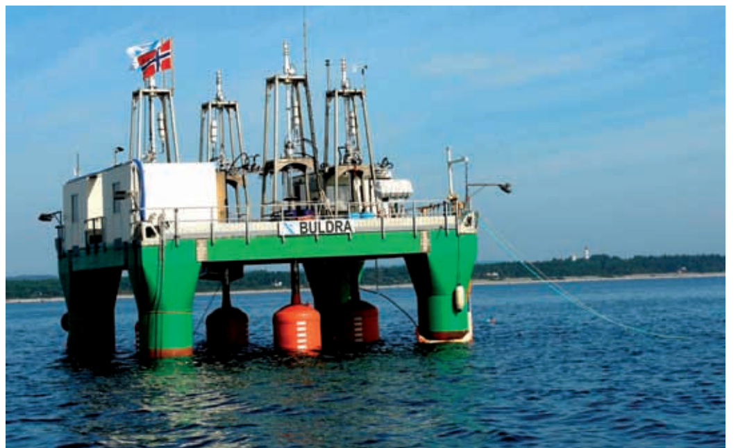
■ FO 3 een punt-absorptiesysteem ontwikkeld in Noorwegen (SEWEC)
