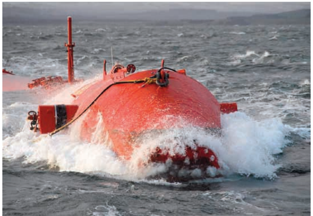
■ Pelamis: prototype 750 kW (Pelamis Wave Power)
