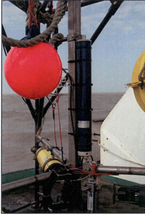
Figuur 7-14 - Detail van de bevestiging van de T-PoD aan de tripod (foto Joan Backers, KBIN/BMM).
