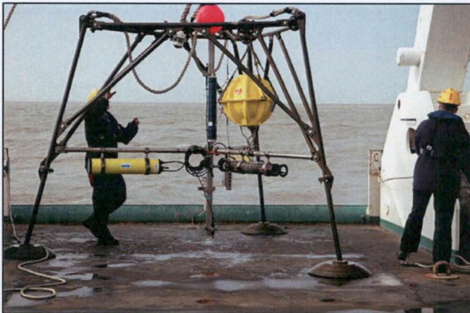
Figuur 7-13 - Tripode, met naast andere meetapparatuur, de T-PoD op de centrale as (foto Joan Backers, KBIN/BMM).
