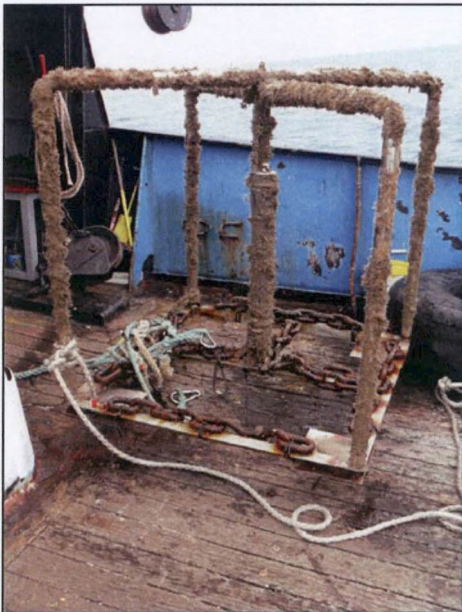
Figuur 7-15 - T-PoD bij het bovenhalen na de laatste verankering. Het frame werd uitgewerkt door de Vlaamse Hydrografie (foto Vlaamse Hydrografie).
