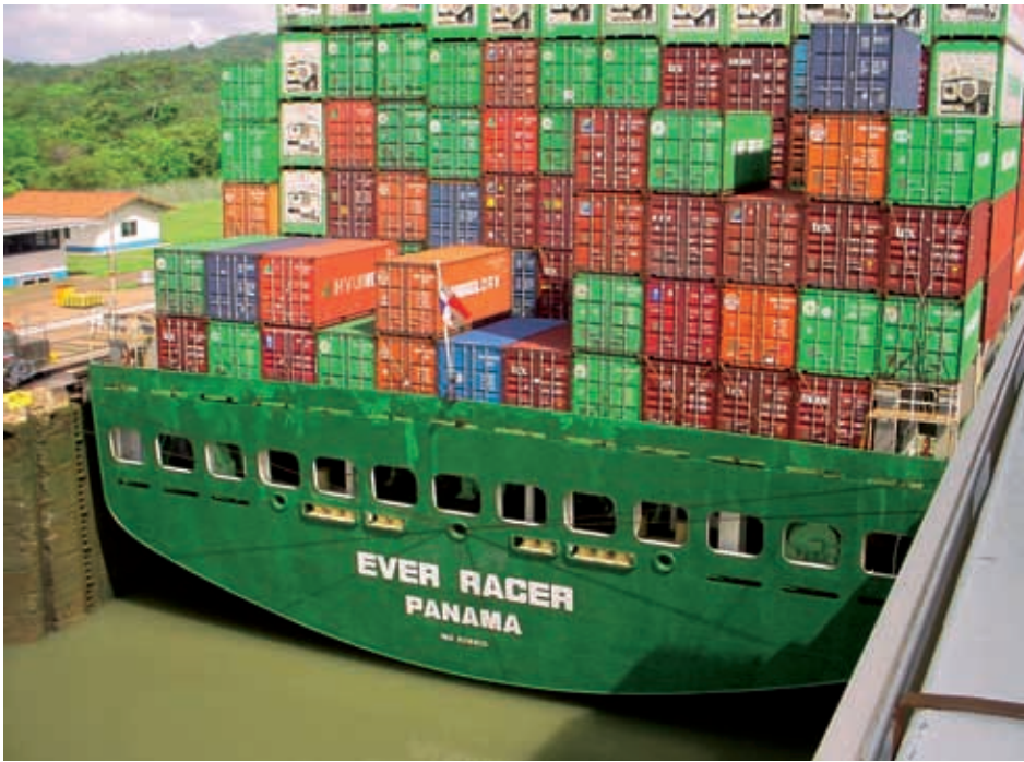
■ Sluizen zijn ontworpen voor bepaalde scheepstypes of om bepaalde combinaties van schepen in één keer te kunnen schutten. De techniek staat echter niet stil en schepen worden steeds groter. In bovenstaande foto is het containerschip Ever Racer te zien terwijl het in de Miraflores sluis (Panamakanaal) gesloten wordt. De afstand tussen de romp van het schip en de wanden van de sluis bedraagt aan weerszijden slechts 60 cm! Het grootste mogelijke containerschip dat in de bestaande sluis van het Panamakanaal past, wordt een "panamax" genoemd. Het kan ongeveer 4500 twintig-voet-containers (20 Engelse voet komt overeen met een lengte van ca. 6 m) vervoeren. (T. De Mulder)
